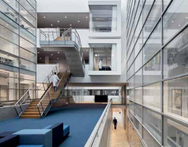
In den Obergeschossen gibt es im Bereich des Atriums verglaste Besprechungsräume, die als eingeschobene Kuben mit klaren, von der Konstruktion freien Glasecken zentral in den Luftraum eingehängt sind.
